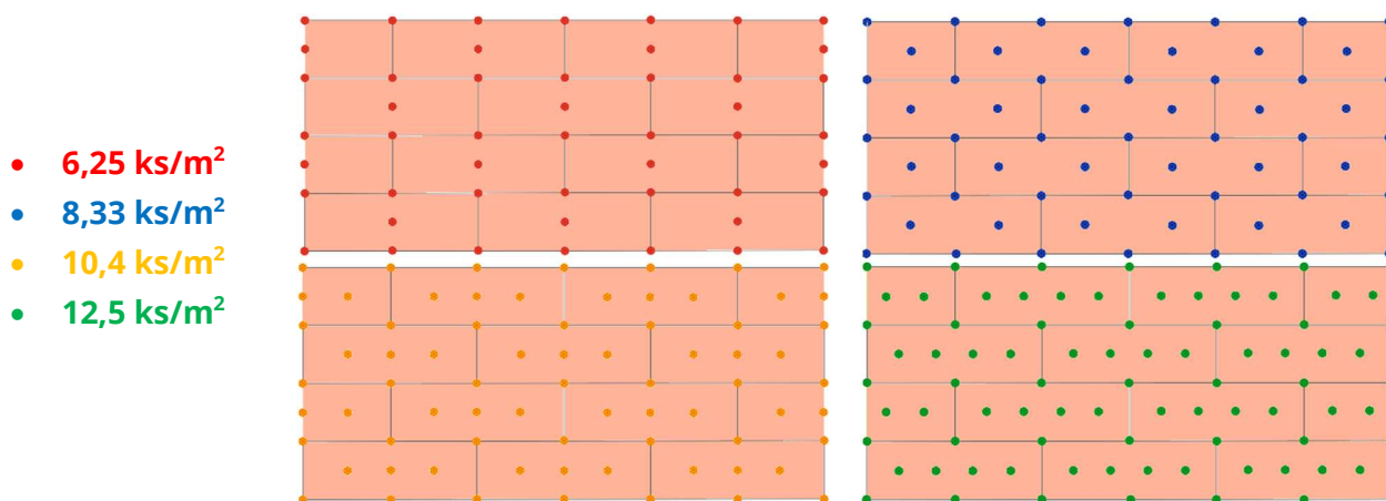
Obr. 6: Doporučený kotevní plán na desky 1 200×400 mm
